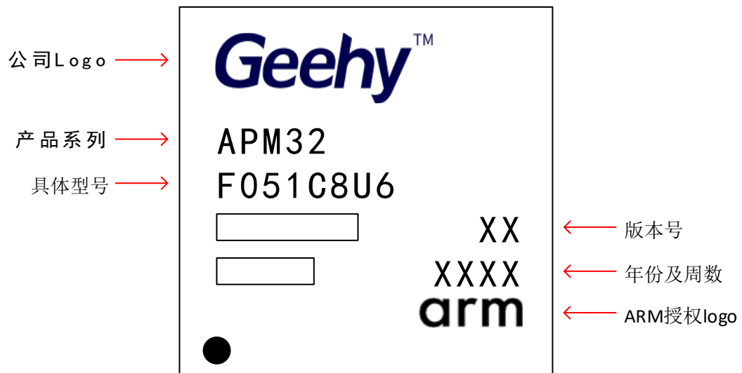
图 27 QFN48 打码规范
