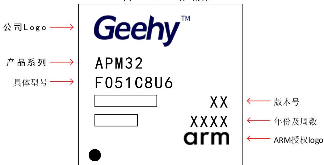
图 27 QFN48 打码规范
