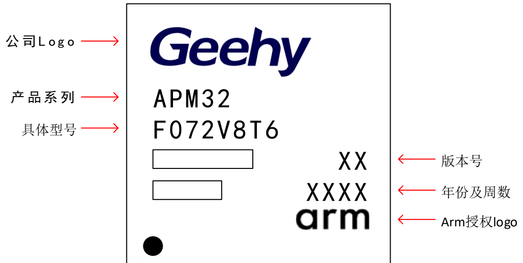
图 18 LQFP100 - 100 引脚，14 x 14mm 封装标识
