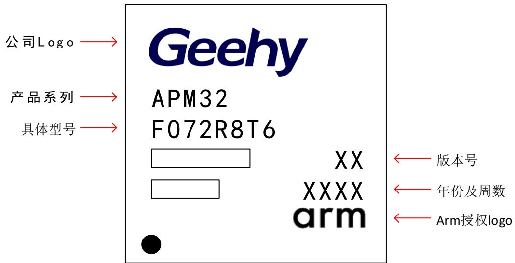
图 21 LQFP64 - 64 引脚, 10 x 10mm 封装标识
