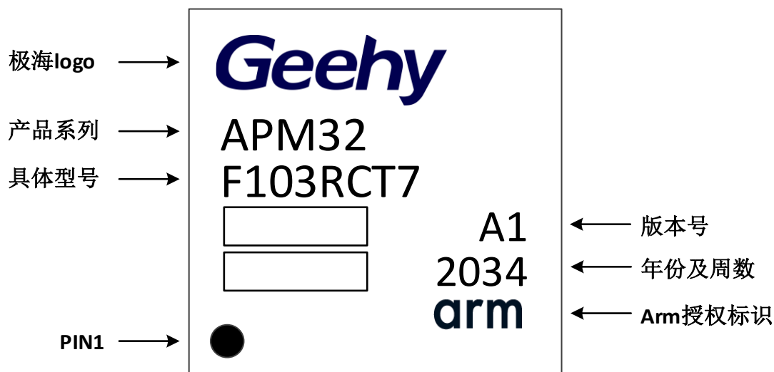
图 16 LQFP64-64 引脚，10×10mm 封装标识
