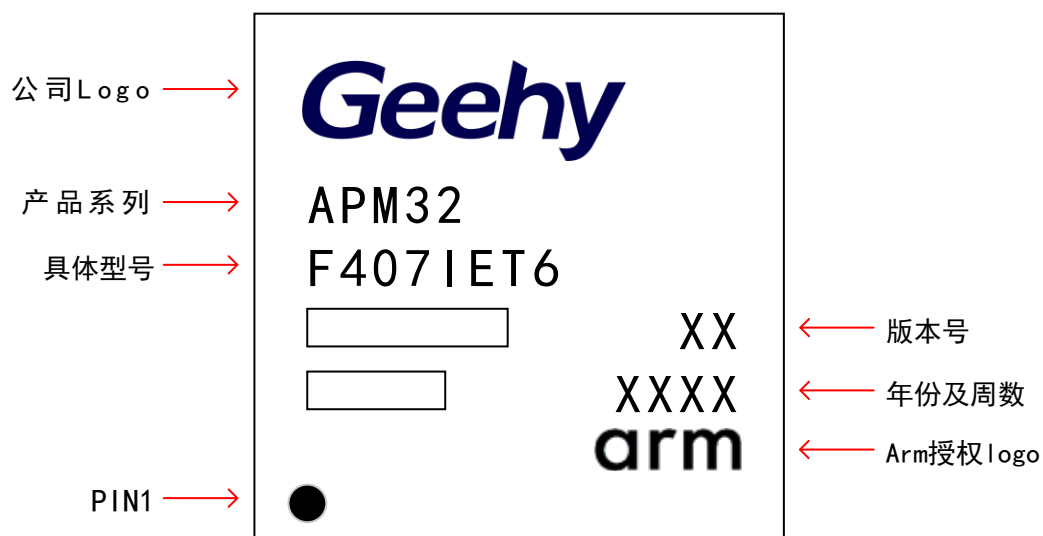
图 18 LQFP176 -176 引脚，24 x24 mm 示意图
