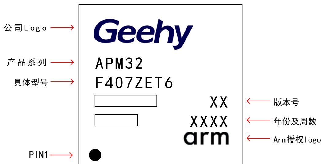
图 21 LQFP144 -144 引脚，20 x20mm 示意图
