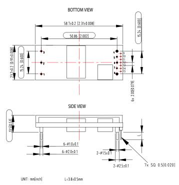
TOLERANCE: X.Xmm±0.5mm[X.XX in.±0.02in.] X.XXmm±0.25mm[X.XXX in.±0.01in.]
