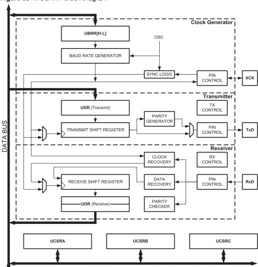
Figure 23-1. USART Block Diagram<sup>(1)</sup>
