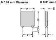
Fig.3 Lead Size : 20AWG Φ 0.81 mm Diameter
