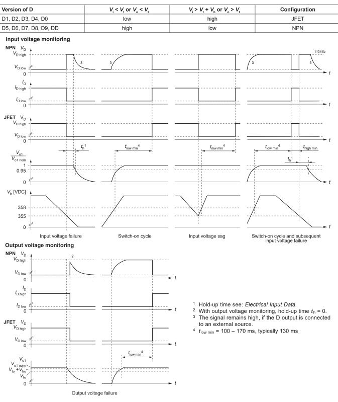
Fig. 40 Relationship between  $V_{\rm b}, V_{\rm o1}, V_{\rm D}, V_{\rm o1}/V_{\rm o1 nom}$  versus time
