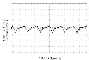
Figure 15. Vo = 1.8 V, Io = Io,max, Vin = 12 V
