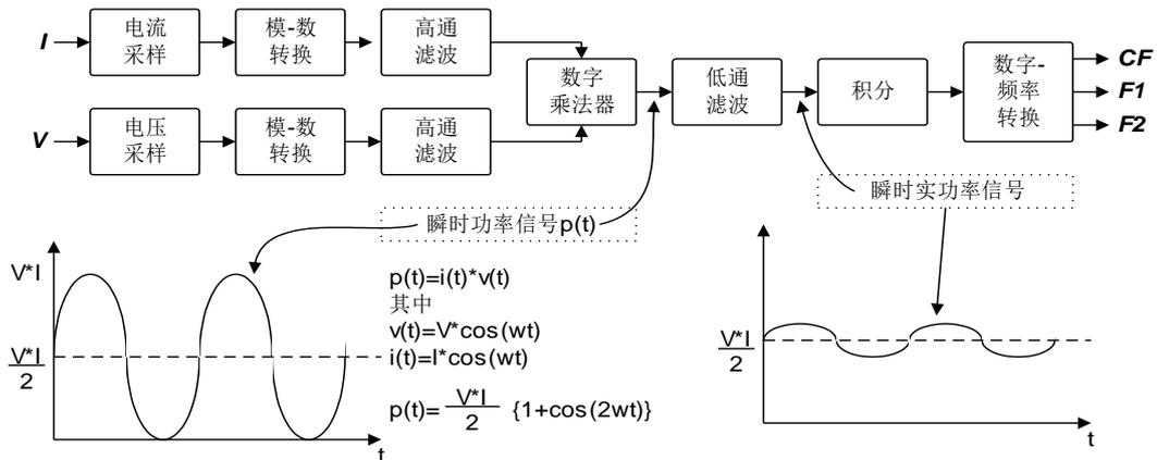
在通过对电流电压信号高精度采样及模数转换后，电流电压信号通过数字乘法器得到瞬态功率信号  $p(t)$ 。让  $p(t)$  通过一个截至频率很低（如 1Hz）的取直低通滤波器，把即时实功率信号取出来。然后对该实功率信号对时间进行积分，得到能量的信息。如果选择积分时间十分的短，可以认为得到的是即时能量消耗的信息，也可以认为是即时功率消耗的信息，因为前后两者成正比关系。如果选择的较长的积分时间，得到的是平均的能量消耗的信息，同样也可以认为是平均功率消耗的信息。
