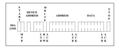
Figure 7. Byte Write
