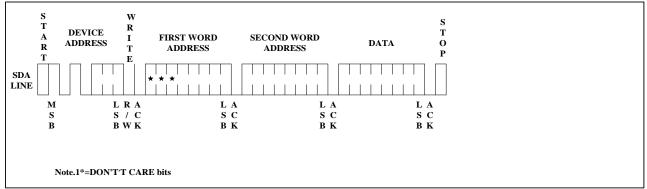
Figure 7. Byte Write
