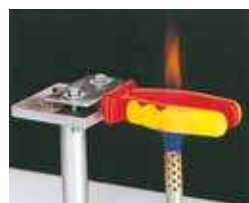
Test wysokotemperaturowy, ogniodporność. High temperature test, flame retardant test.
