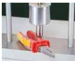
Test na niską temperaturę. Low temperature test.
