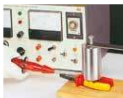
Test ciśnieniowy. Indentation test.
