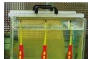
Próby w wodzie właściwości dielektrycznych na 10000 V. Dielectric water bath test at 10000 V.
