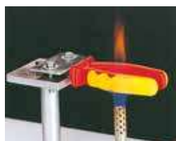
Test wysokotemperaturowy, ognioodporność. High temperature test, flame retardant test.
