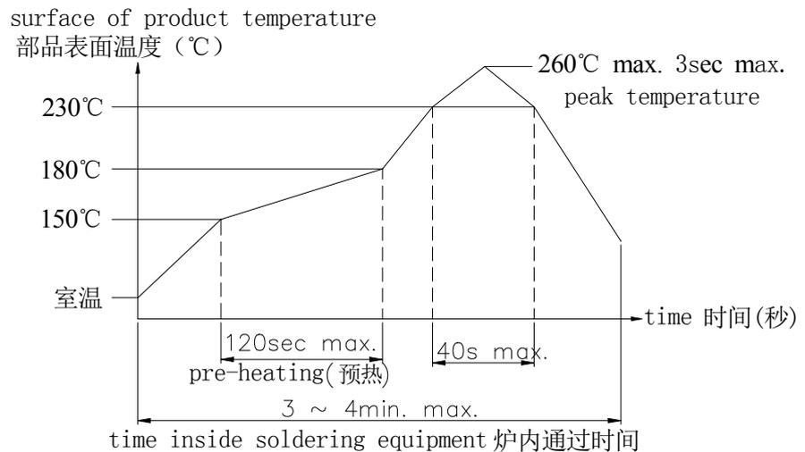
注意：以上提及的条件是零部件上PWB表面的温度，由于PWB的材料、尺寸、厚度等不同，PWB从开关表面获得的温度也会有很大不同，因此，千万小心不要让开关表面温度超过260°C
