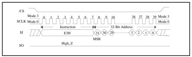
Figure 177. SPB Program (QPI Mode/3-Byte Address Mode)
