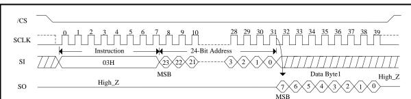
Figure 35. Read Data Bytes Sequence Diagram (SPI Mode/3-Byte Address Mode)
