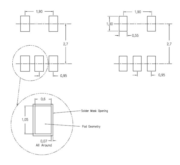
RECOMMENDED PCB LAYOUT PATTERN (Unit: mm)
