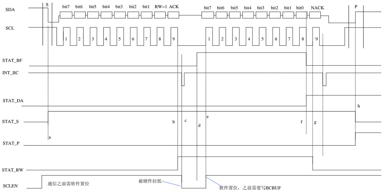
图 15 IIC 主机读示意图
