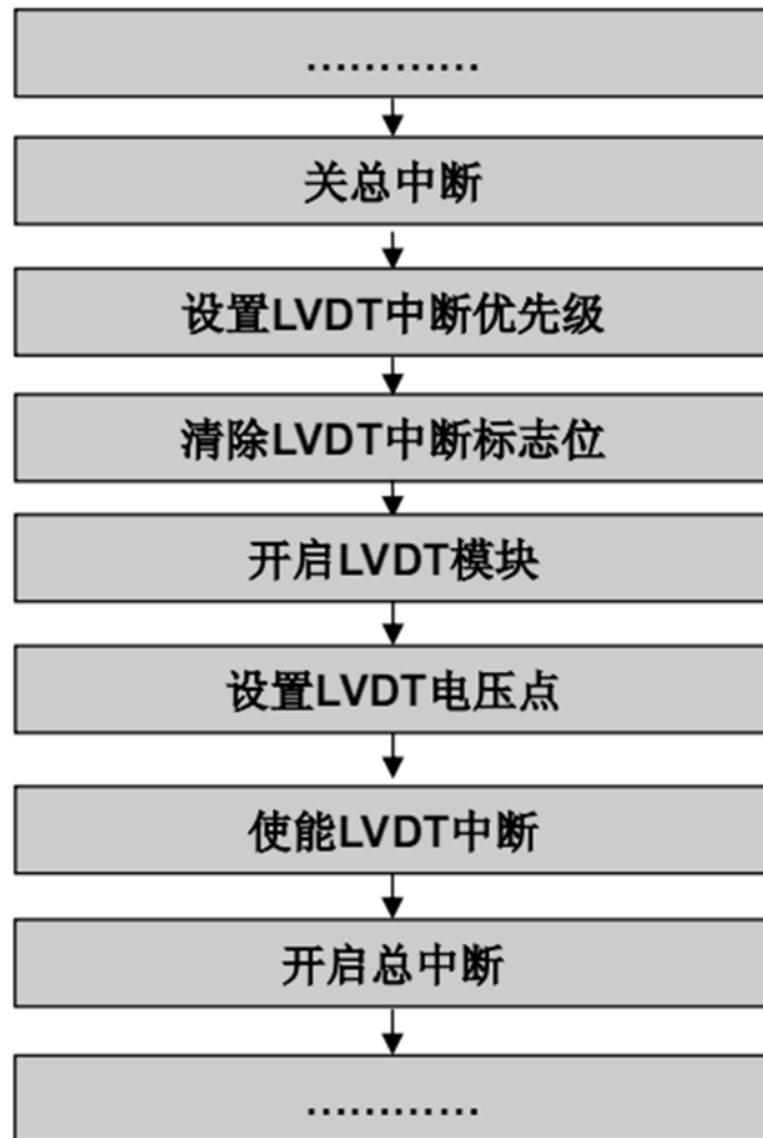
LVDT 低电压检测配置流程
