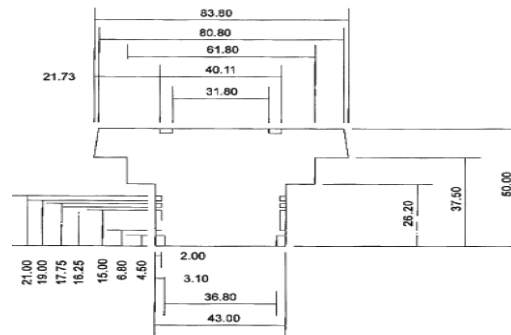
CMEB/E max PCB Dimensions
