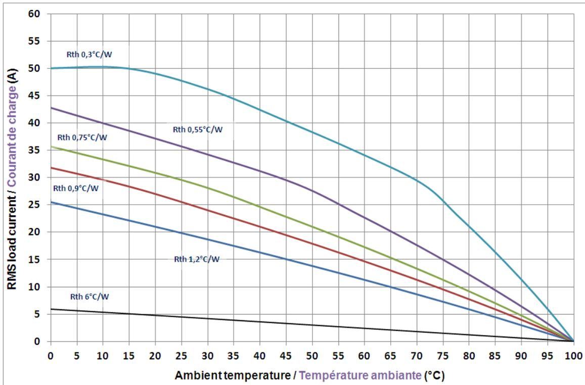
Standard celduc heatsinks / Dissipateurs celduc standard:
