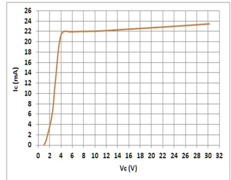
**Output characteristics (at 25°C) / Caractéristiques de sortie (25°C)**
