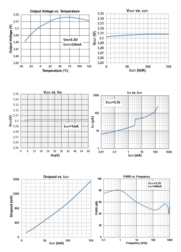
(V<sub>CE</sub>=V<sub>IN</sub>=V<sub>OUT</sub>+2V, C<sub>IN</sub>=1 $\mu$ F, C<sub>OUT</sub>=10 $\mu$ F , T<sub>A</sub>=25 $^{\circ}$ C,unless otherwise specified)
