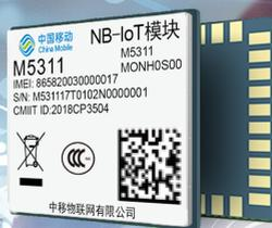
M5311 是一款高性能、低功耗 NB-IoT 无线通信模组，满足中国移动蜂窝物联网通用模组技术规范。尺寸仅为 16mm × 18mm × 2.2mm，能够最大限度地满足终端设备对小尺寸模块产品的需求，有效地帮助客户减小产品尺寸并优化产品成本。M5311 采用 LCC 封装，可通过标准 SMT 设备实现模块的快速生产，为客户提供可靠的连接方式，并满足苛刻环境下的应用需求。
