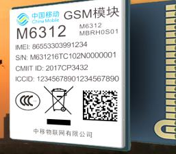
M6312 是一款工业级 GSM/GPRS 通信模组。支持 GPRS class 10 和 GPRS CS-1、CS-2、CS-3、CS-4 编码。M6312 采用 LCC 封装方式，具有高性价比、低功耗、抗干扰能力强的特点。可向电力、石油、水务、燃气、交通、金融等行业客户提供可靠的 M2M 通信功能。
