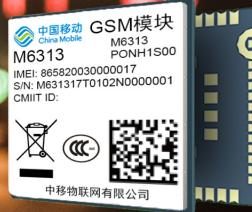
M6313 模组是一款工业级的 GSM/GPRS/GNSS 无线通信模组，其工作频段为 850/900/1800/1900MHz，GNSS 支持 GPS/BDS 等定位系统。尺寸仅有 18.7mm x 16.0mm x 2.7mm，可以广泛应用于车载设备、定位设备、智能抄表、可穿戴设备、共享设备等领域。
