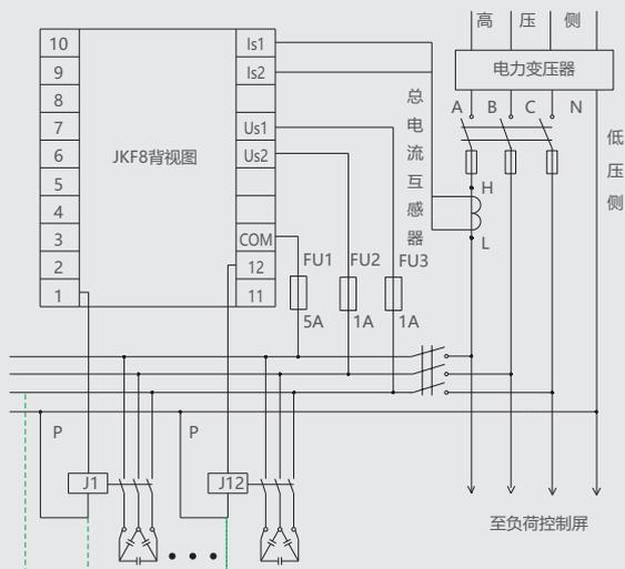
注：当接触器线圈电压为220V时P点接N相，
