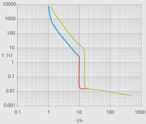
图28 NM1LE-800 温度补偿曲线
