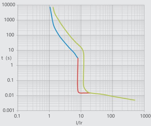
图18 NM1LE-400 温度补偿曲线
