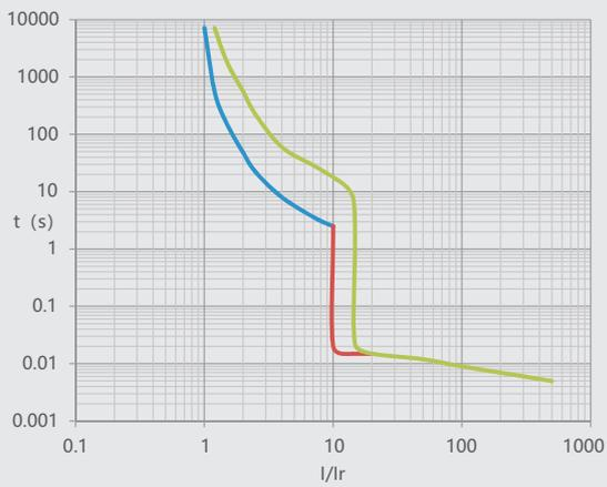
图12 NM1LE-125 >63A 温度补偿曲线
