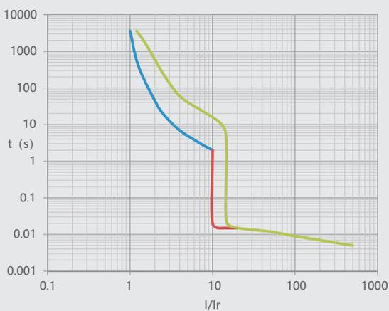
图8 NM1LE-125 32A-63A 温度补偿曲线
