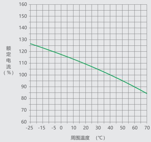
图13 NM1LE-250 配电保护
