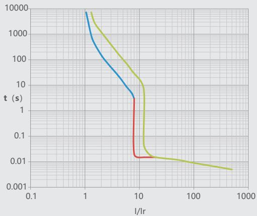
图26 NM1LE-800 温度补偿曲线
