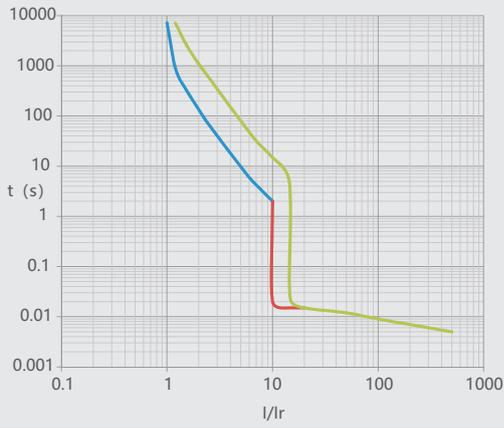
图24 NM1LE-630 温度补偿曲线
