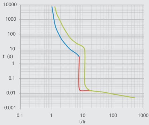
图14 NM1LE-250 温度补偿曲线
