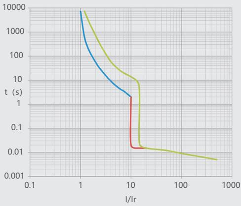
图16 NM1LE-250 温度补偿曲线
