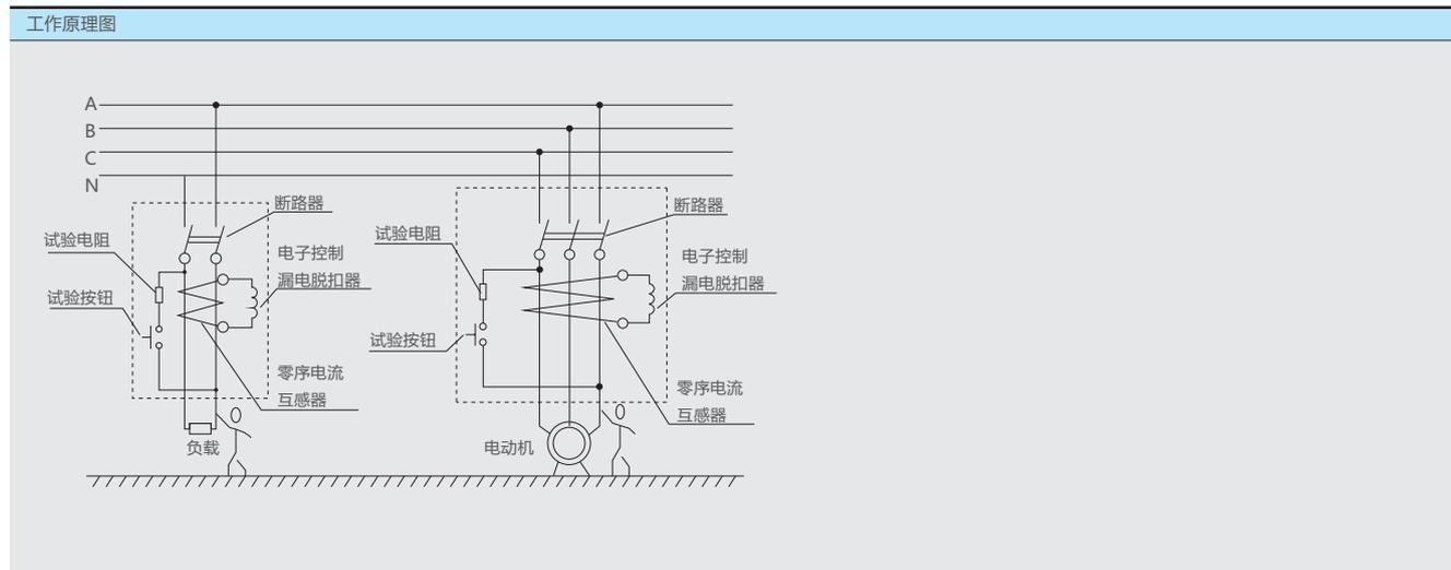
7.2.3 当被保护电路出现过载或短路时，热磁式脱扣器完成延时或瞬时脱扣动作而使剩余电流动作断路器动作，从而切断电源起到过载或短路保护作用。
