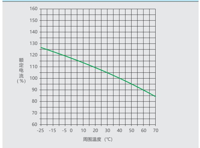
图3 NM1LE-125 16A~25A电动机保护
