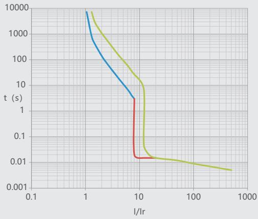
图22 NM1LE-630 温度补偿曲线
