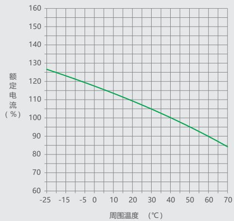
图7 NM1LE-125 32A-63A电动机保护
