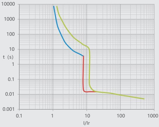
图10 NM1LE-125 >63A 温度补偿曲线
