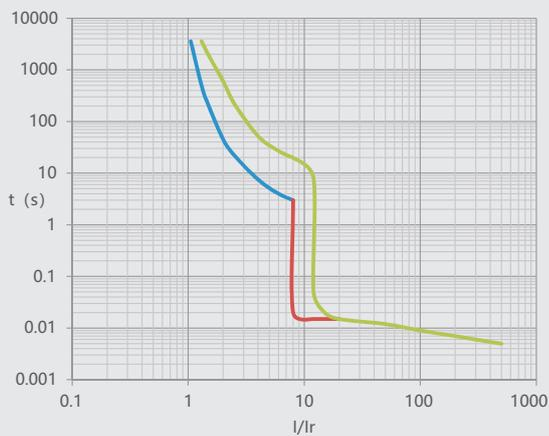
图6 NM1LE-125 32A-63A 温度补偿曲线
