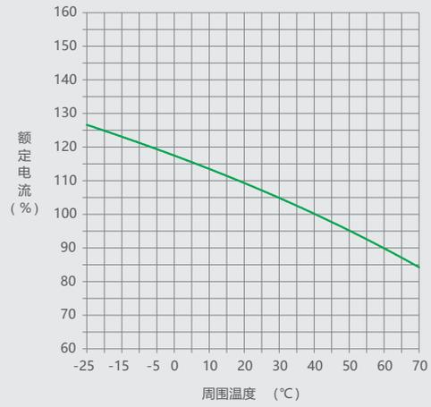
图11 NM1LE-125 >63A 电动机保护
