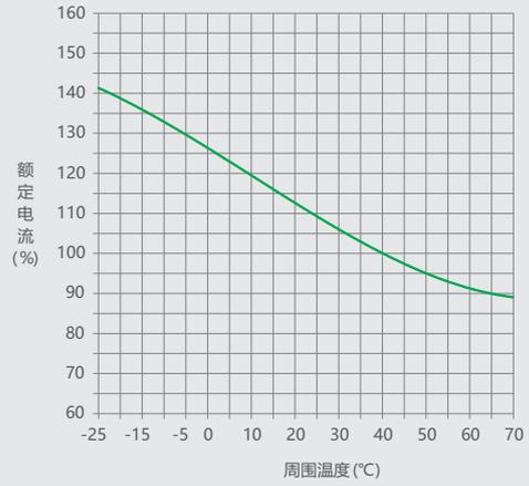
图25 NM1LE-800 配电保护
