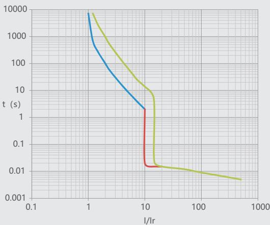
图20 NM1LE-400 温度补偿曲线
