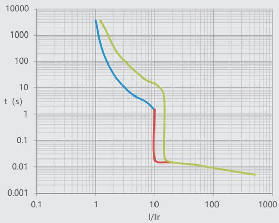
图4 NM1LE-125 16A-25A 温度补偿曲线
