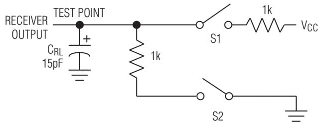
图6 接收器启用/禁用时序测试负载
