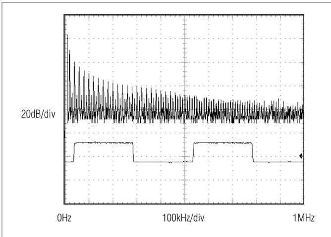
图16 CLM3083E / CLM3084E / CLM3085E和SRL = VCC 时的CLM3089E发送20kHz信号时，驱动器输出波形和FFT图
