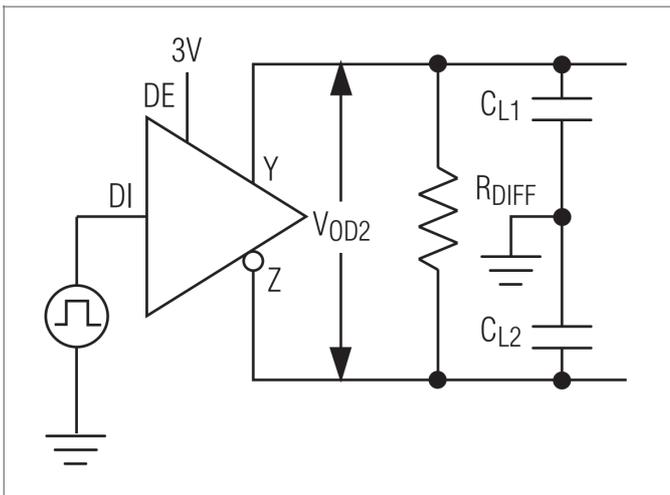
图7 驱动器时序测试电路
