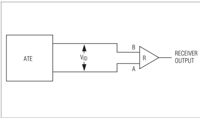
图13 接收器传输延时测试电路
