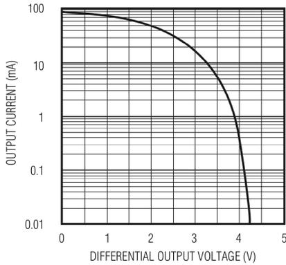
输出电流与驱动器输出低电压的关
