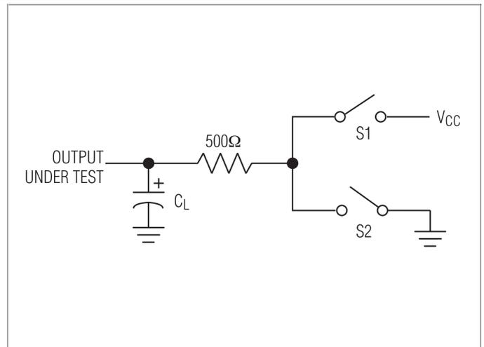
图8 驱动器程序启用和禁用时序测试负载
