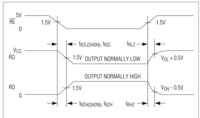
图12 接收器启用和禁用时序图 ( CLM3081E / CLM3084E / CLM3087E除外 )
