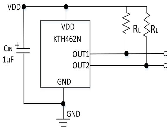
**注:** 为了滤除芯片电源端的噪声, 电源和地之间需连接一个1uF 电容, 且电容尽量接近VDD引脚。
