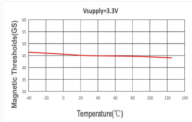
Y 轴磁场磁滞 VS 工作温度 @VDD=3.3V
