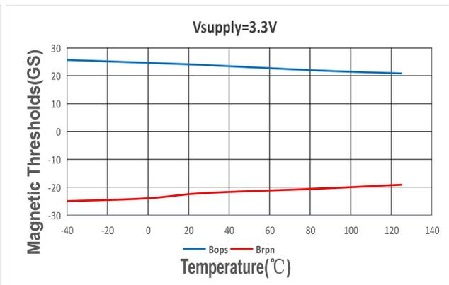
Z 轴磁场阈值 VS 工作温度 @VDD=3.3V
