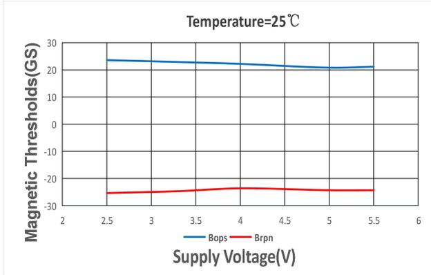
X 轴磁场阈值 VS 供电电压 @TA=25°C
