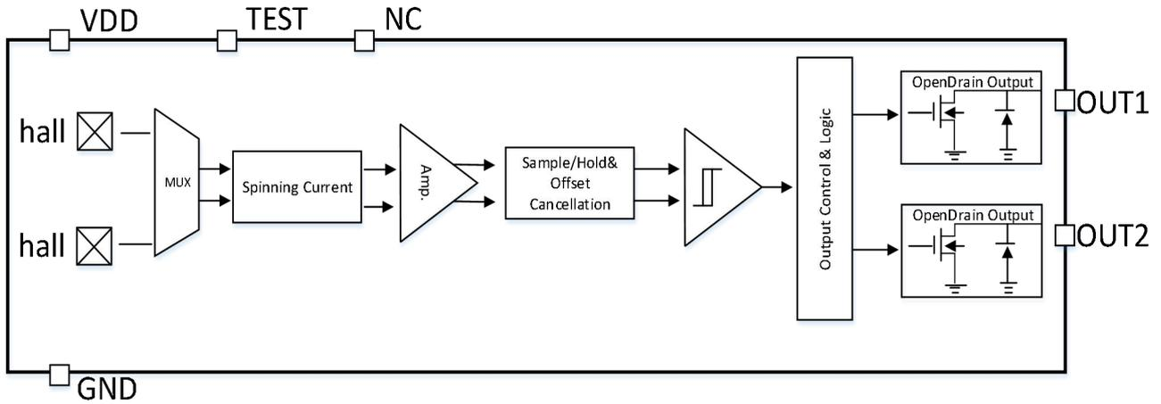
注：不同型号的芯片内部集成了三种不同组合的霍尔盘(X-Y, X-Z, Y-Z)。
