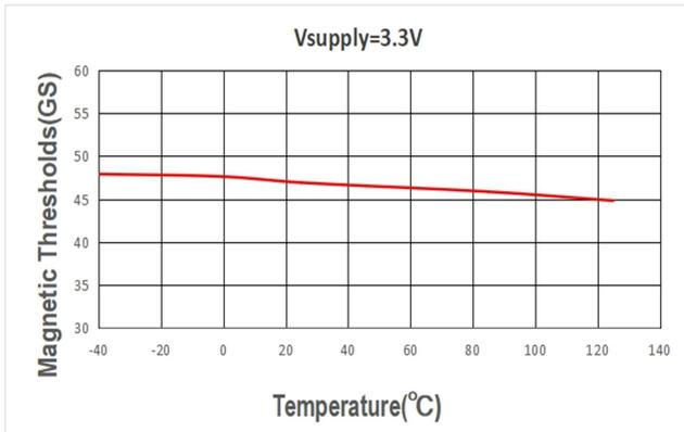
X 轴磁场磁滞 VS 工作温度 @VDD=3.3V
