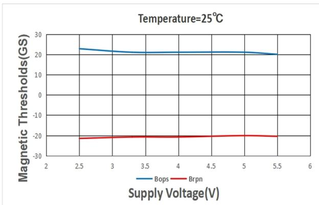
Y 轴磁场阈值 VS 供电电压 @TA=25°C
