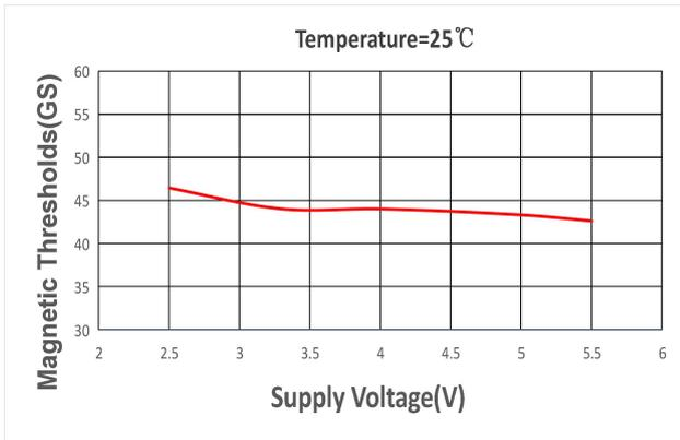
Y 轴磁场磁滞 VS 供电电压 @TA=25°C
