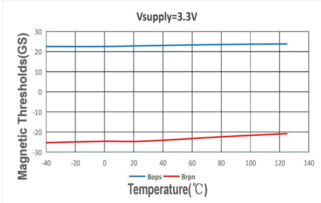
X 轴磁场阈值 VS 工作温度 @VDD=3.3V
