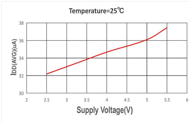
平均电流 VS 供电电压 @TA=25°C
