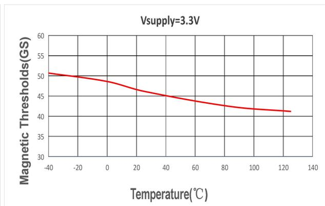
Z 轴磁场磁滞 VS 工作温度 @VDD=3.3V
