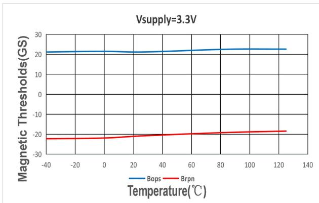
Y 轴磁场阈值 VS 工作温度 @VDD=3.3V
