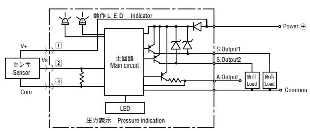
※2 線式電流出力センサを使用する場合、(Com.)は N.C. とします。
