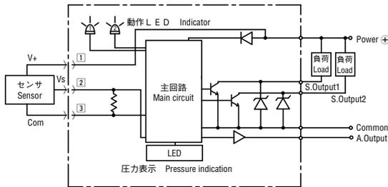
・ 電圧入力 PNP 出力 Voltage input PNP output
