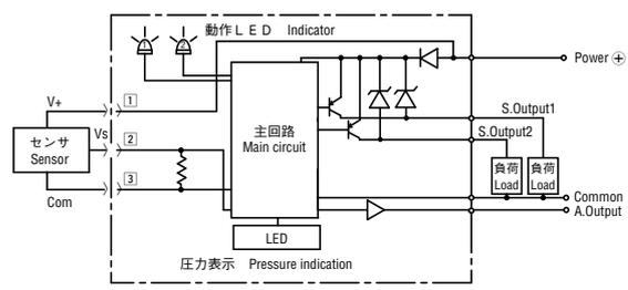
※2 線式電流出力センサを使用する場合、(Com.)は N.C. とします。
