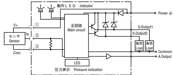
・ 電圧入力 NPN 出力 Voltage input NPN output
