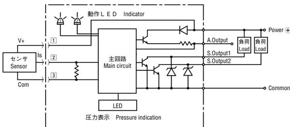
・ 電流入力 PNP 出力 Current input PNP output
