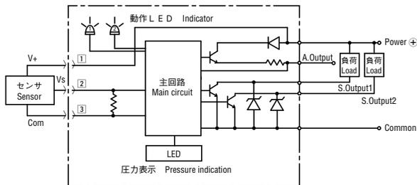
・ 電圧入力 PNP 出力 Voltage input PNP output
