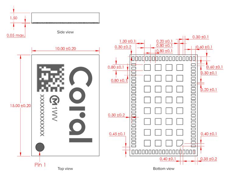
Figure 8. Module dimensions
