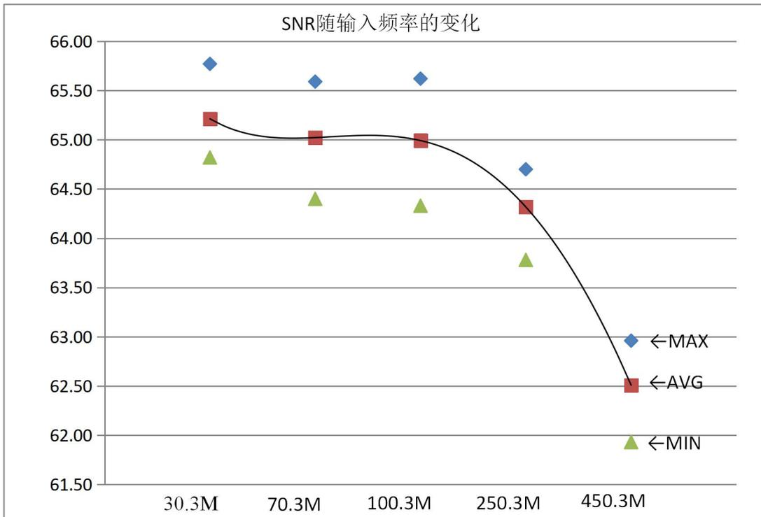
图5 SNR 随采样频率变化曲线
