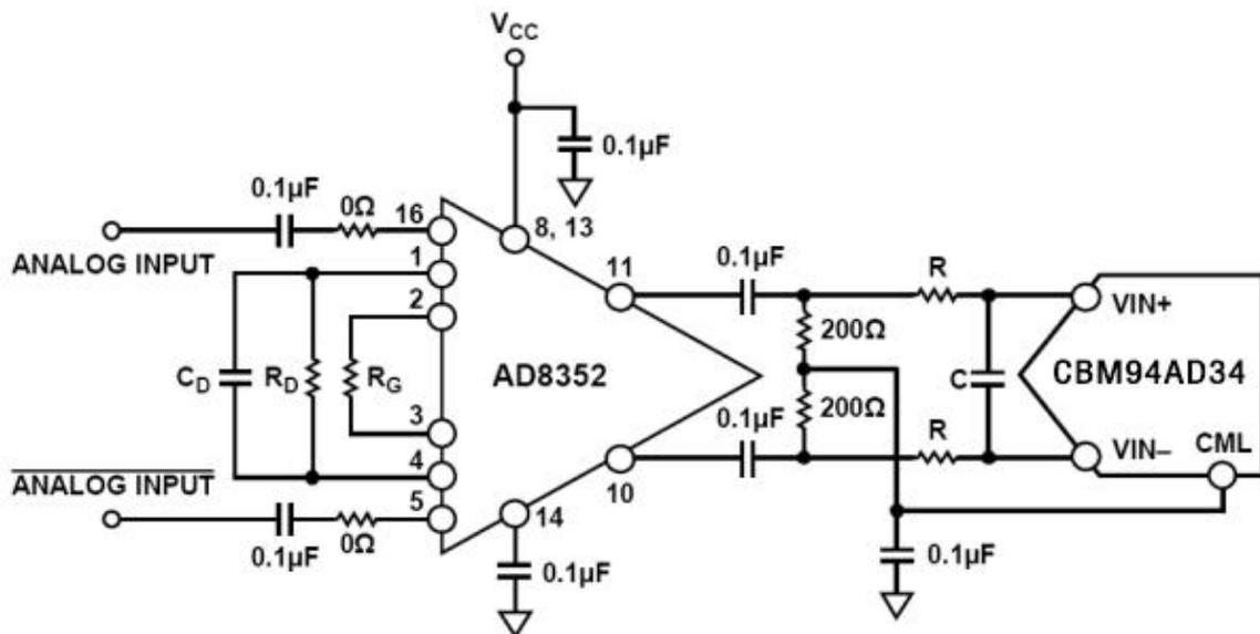
图 9 利用 AD8352 进行差分输入配置
