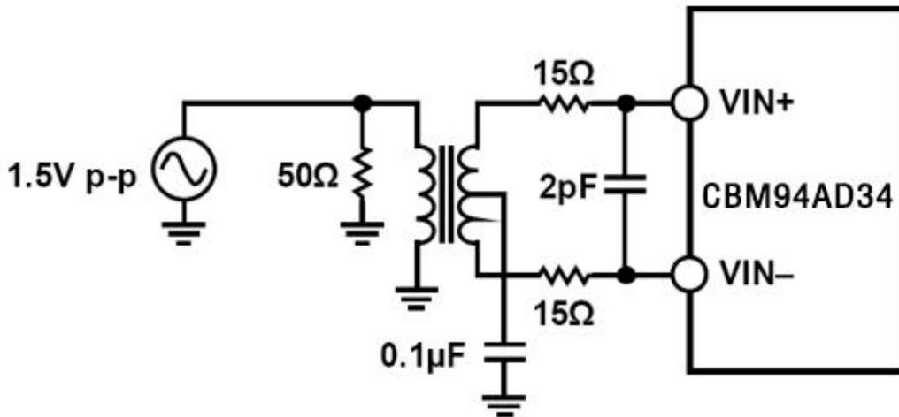
图 8 差分变压器耦合配置
