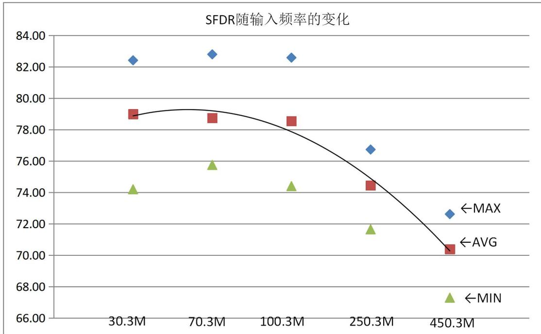
图 6 SFDR 随采样频率变化曲线
