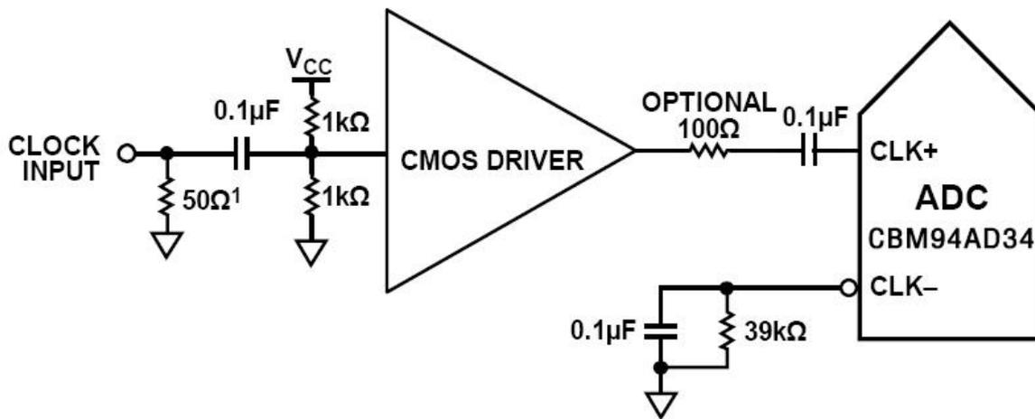
图 13 单端 1.8 V CMOS 输入时钟
