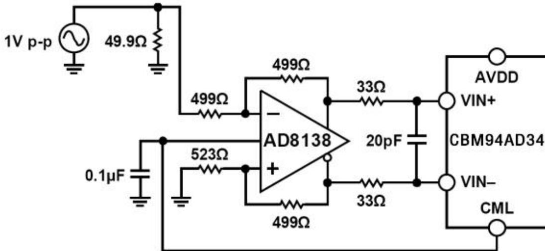
图 7 利用 AD8138 进行差分输入配置
