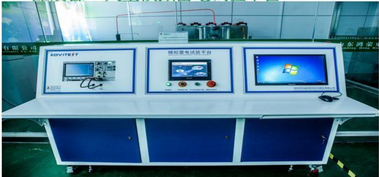
品质部：大型模拟雷电试验平台
