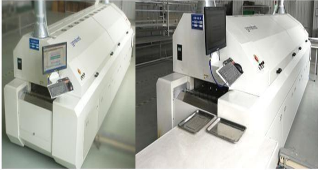
工厂车间图：SPD、TMOV回焊炉站
