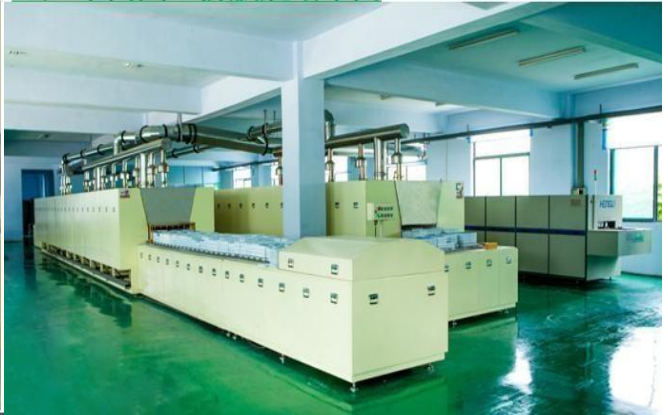
工厂车间图：排胶烧结车间
