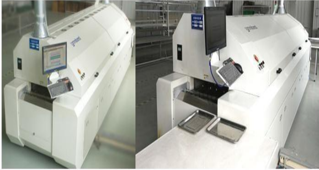
工厂车间图：SPD、TMOV回焊炉站
