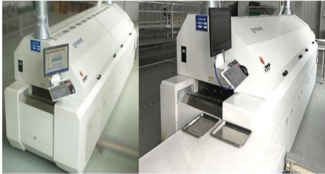
工厂车间图：SPD、TMOV回焊炉站
