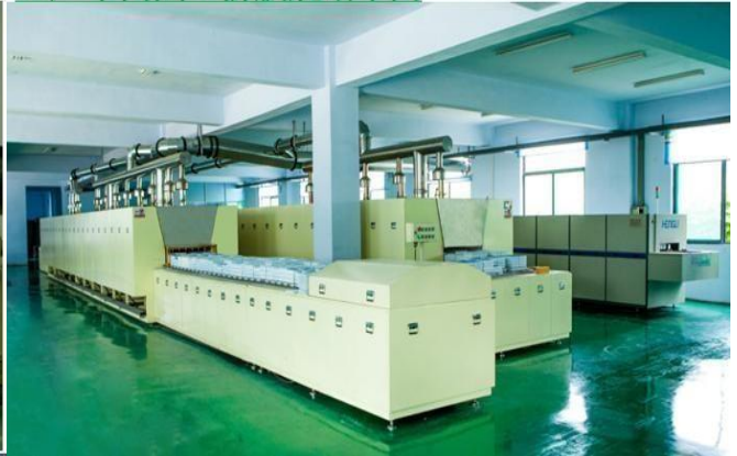
工厂车间图：排胶烧结车间
