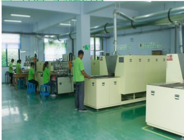
工厂车间图：涂银还原车间
