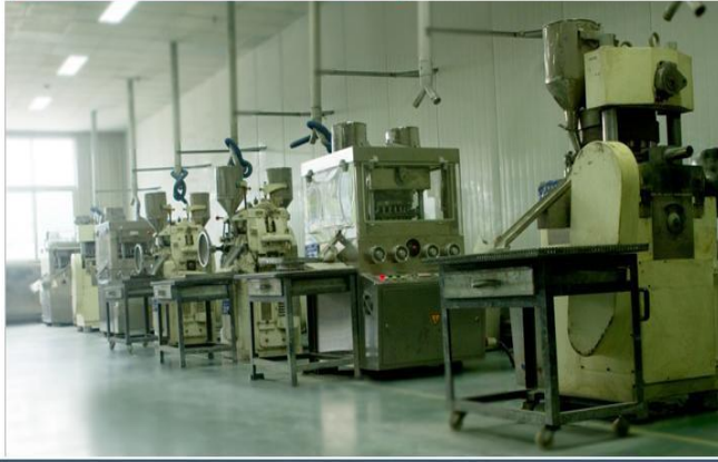
工厂车间场景图：压片车间
