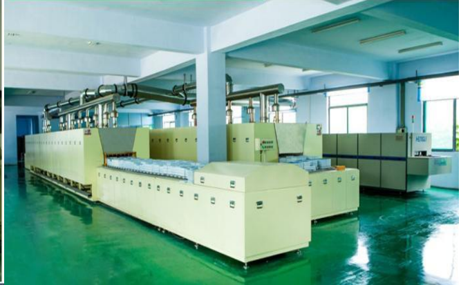
工厂车间图：排胶烧结车间
