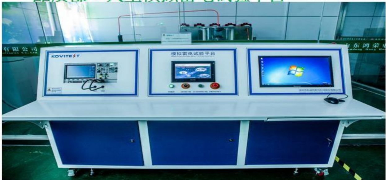
品质部：大型模拟雷电试验平台
