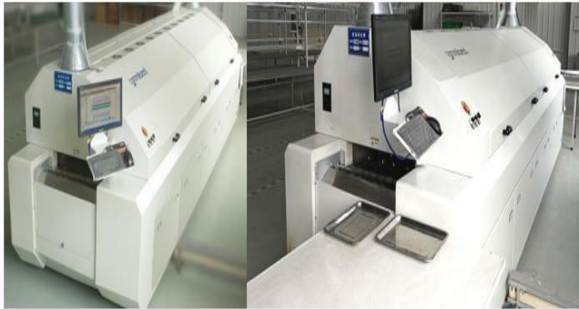
工厂车间图：SPD、TMOV回焊炉站
