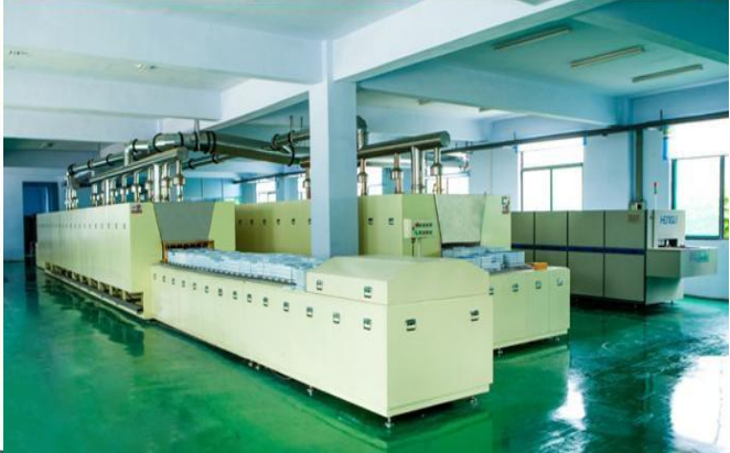
工厂车间图：排胶烧结车间
