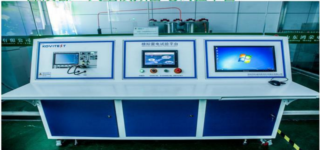
品质部：大型模拟雷电试验平台
