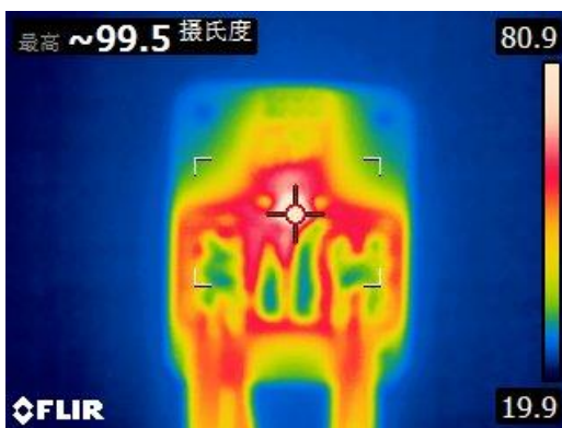
封装体热成像图 (输入电流 40A)
